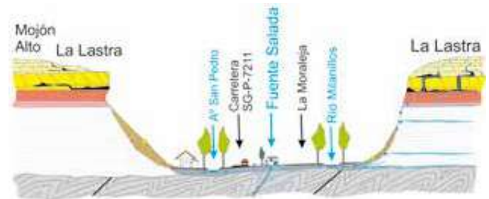
Corte hidrogeológico idealizado transversal al valle del río Milanillos, con la disposición de los diferentes acuíferos y acuitardos que pueden estar relacionados con la Fuente Salada.
